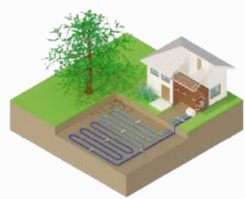
Pompe à chaleur sur capteurs enterrés horizontaux
