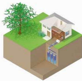
Pompe à chaleur sur corbeilles géothermiques
